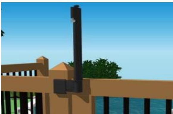
Exemple de loquet pouvant être installé du côté extérieur de l'enceinte lorsque le bouton de déverrouillage est situé à au moins 1,5m du sol.
