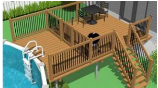
Exemple de terrasse rattachant la piscine à la résidence. La clôture empêchant l'accès à la piscine doit toujours avoir au moins 1,2 m de hauteur.
